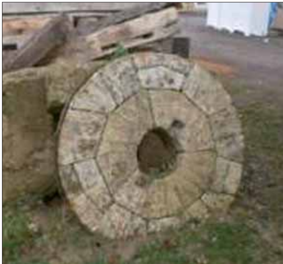
Erhaltene Mühlsteine mit Schärfe für Linksdrehung. Links französischer Süßwasserquarzit als Läufer des Feinmehlgangs mit Aussparungen für die Haue mit Unterantrieb; rechts: der Bodenstein aus Basalt mit Bogenschärfe für den Schrotgang.
