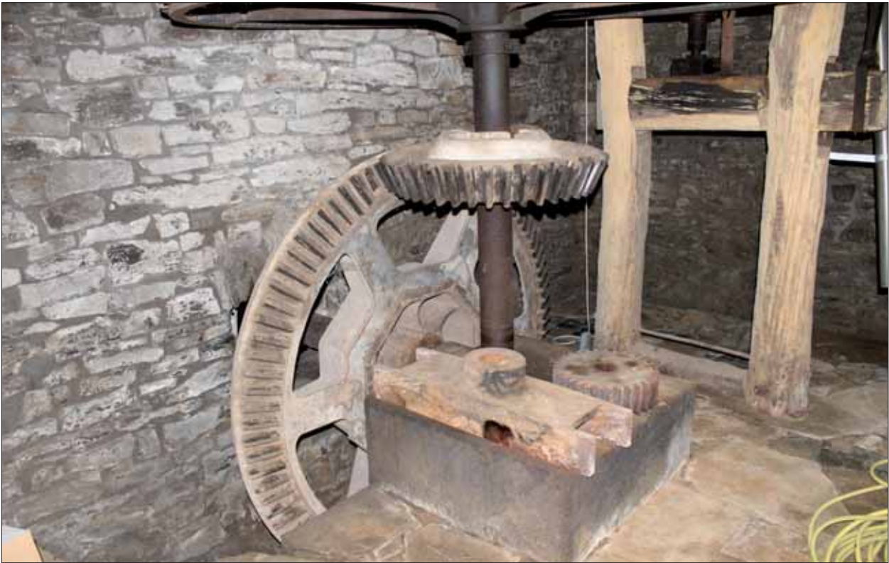
IIIbc-2-3-6-BirM14-S-040 Birkenmühle. Antriebskeller: Winkelgetriebe mit Vorgelege (stehendes Zeug); hinten Tellerrad (2) auf der Wasserwelle (1), mittig: unten das Ritzel (3) und oben ein großes Stirnrad (4) auf der Königswelle; davor liegen ein Spurlager und ein weiteres Ritzel. Im Hintergrund rechts das hölzerne Lichtwerk (6).
