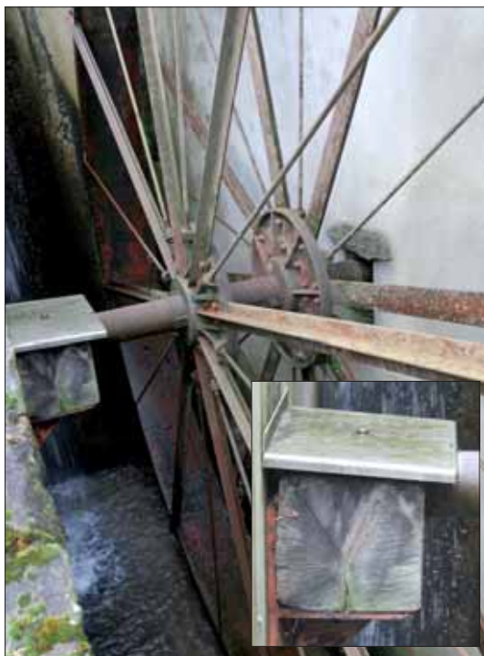
Ile-BirM14-S-032 Birkenmühle, außen: Das Mühlrad (e) der Birkenmühle und sein äußeres Lager im Holzblock.
