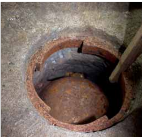
IIId1-7-BirM14-S-062 Birkenmühle, Mahlboden: Steinmahlgang (7); Blick auf den Mahlstein: Steinauge mit Nockenring, Rüttelstecken, zweiarmige Kugelkopfhäue.
