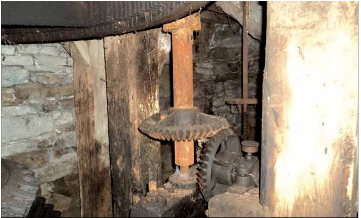
III da -4-6-7-MVe14-K-044 Pulvermühle Velken, innen: Antriebskeller, Stehendes Zeug: Königsrad [4], Mühleisen mit Ritzel für Transmission [8a], hinten: Spindel des Lichtwerks [7].
