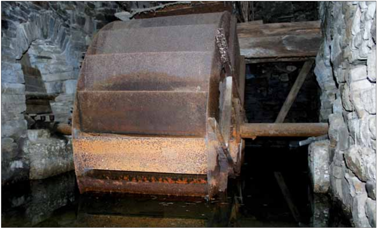
IIIe-MVe14-K-081 Pulvermühle Velken, innen, Radkammer: Oberschlächtiges Zellenrad [e] von NW.
