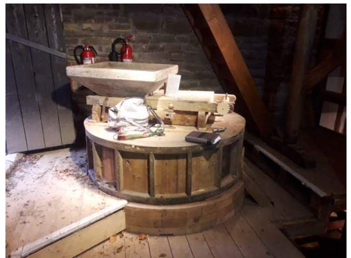
Mahlgang mit Bütte und Schüttvorrichtung in der Mühle. Vermutlich aus der Gaderother Mühle. Zeigt Restaurierungsspuren an der Bütte, © RMDZ 2024.
