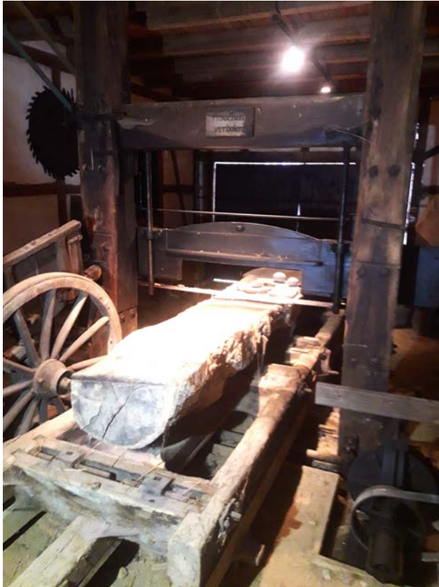
Vermutlich originale horizontale Säge mit Schlitten aus der Gaderother Mühle, © RMDZ 2024.
