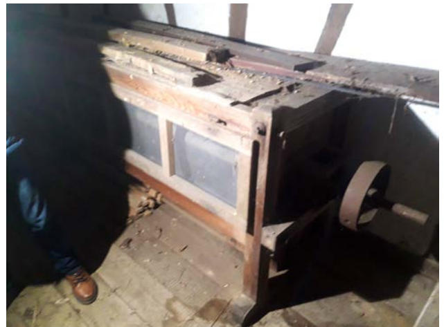
Abgestellter Sechskantsichter von Wetzig, © RMDZ 2024.
