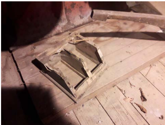
Aufgefundener Plansichterauslauf aus der Gaderother Mühle, © RMDZ 2024.
