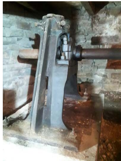
Antrieb vom 2. Mahlgang, vermutlich aus der Gaderother Mühle, © RMDZ 2024.
