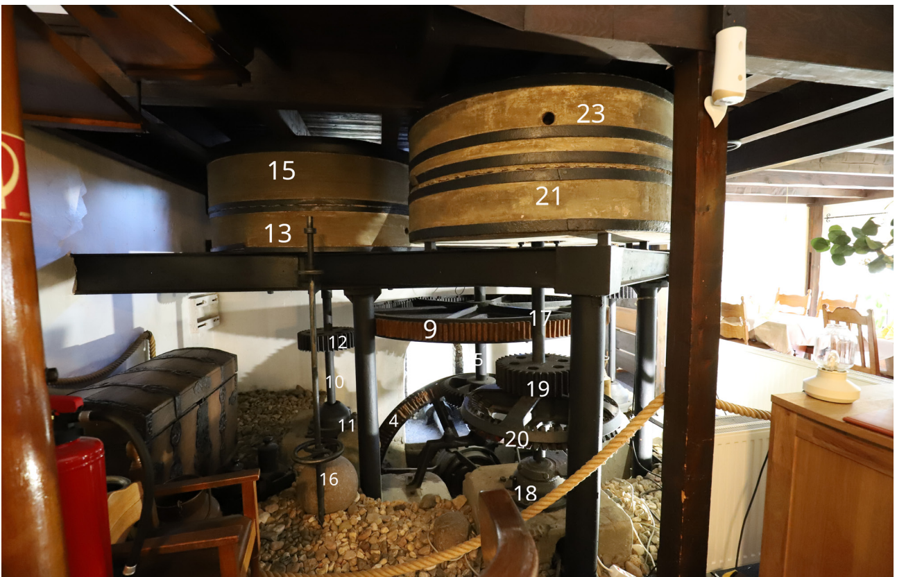
Mahlstuhl, Mühlentriebwerk, Mahlgänge 1 und 3
