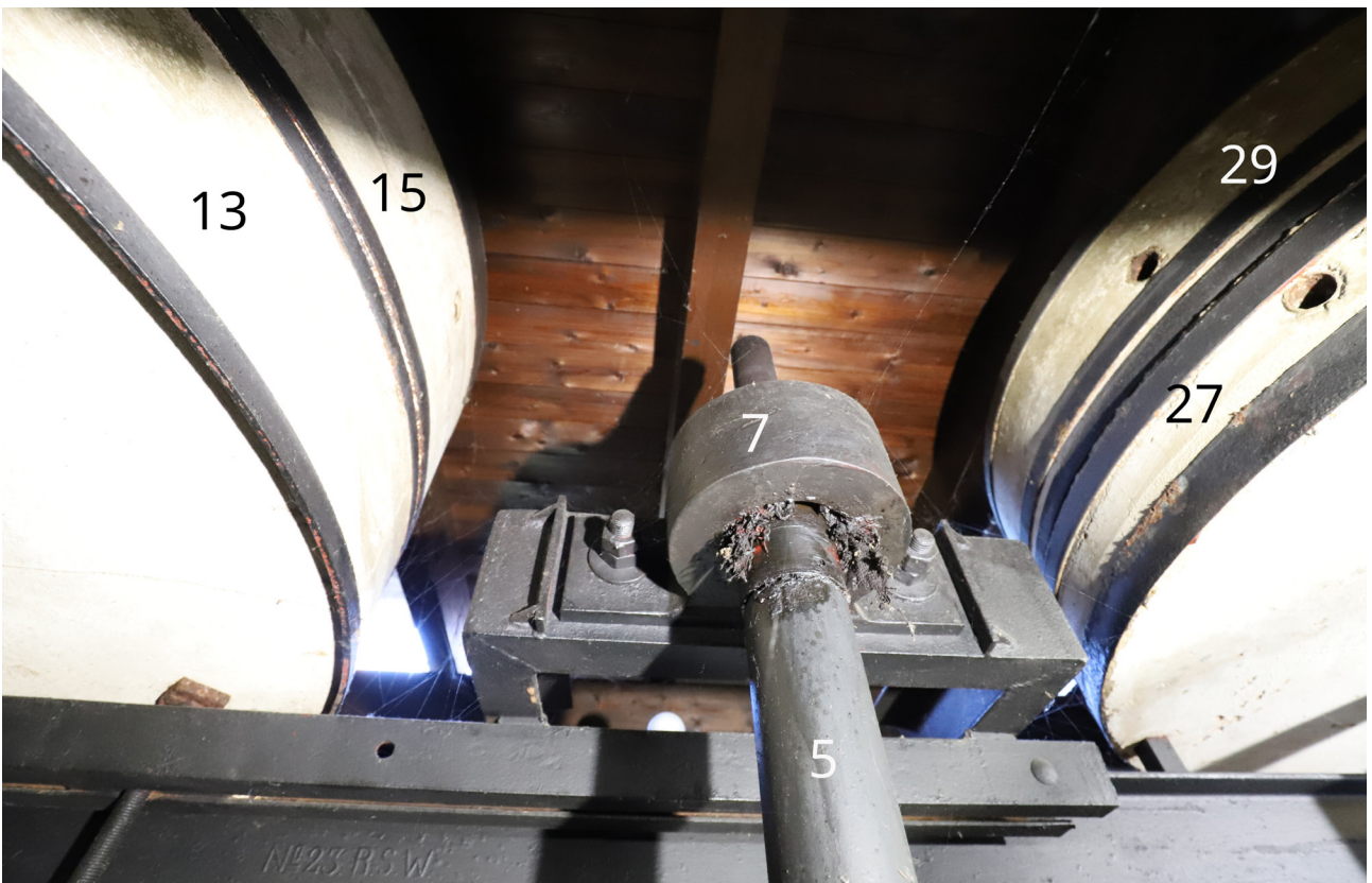
Mahlstuhl, Mühlentriebwerk, Mahlgänge 1 und 2, Königswelle
