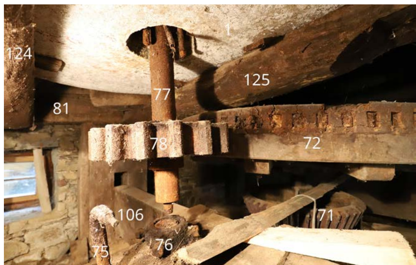
2.41 | Unteres Kellergeschoss, Mahlstuhl: Lichtwerk und Mühleisen von Mahlgang 1, stehendes Vorgelege.
