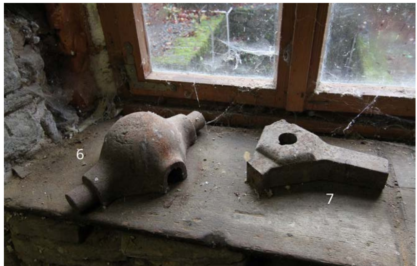
1.12 | Oberes Kellergeschoss: Kugelkopfhaue und Dreiarmhaue.
