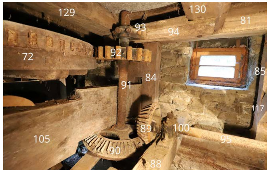
2.59 | Unteres Kellergeschoss, Mahlstuhl: Antrieb der unteren Riementransmissionswelle (95) über Kegelradwinkelgetriebe.
