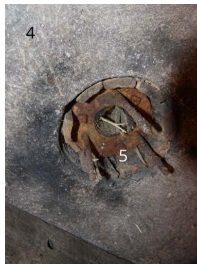
1.26 | Unteres Kellergeschoss: Lieger von Mahlgang 2 von unten (Detail).
