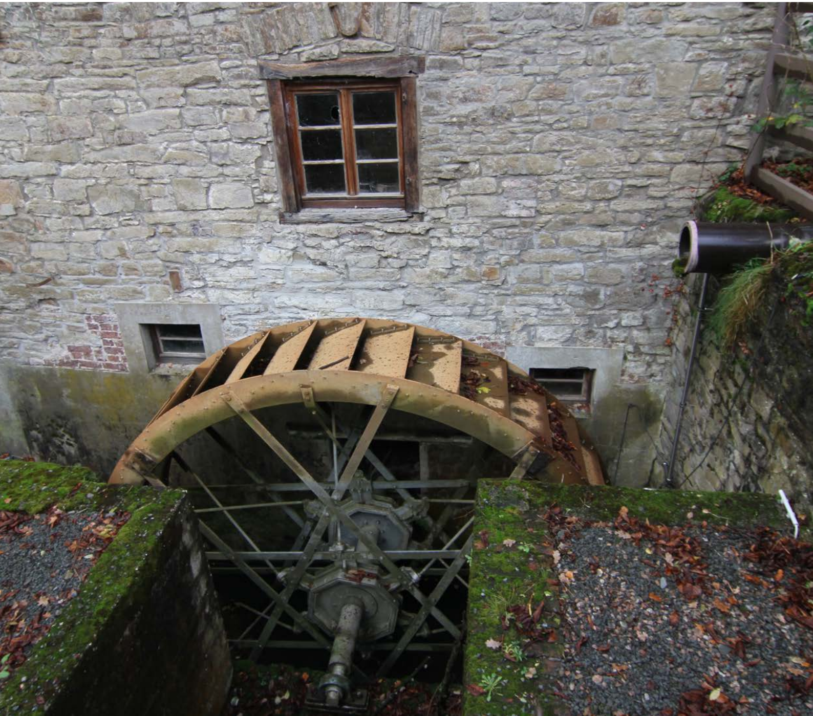
Das overschlächlige Wasserrad der Kupfersiefer Mühle im Dezember 2024.
